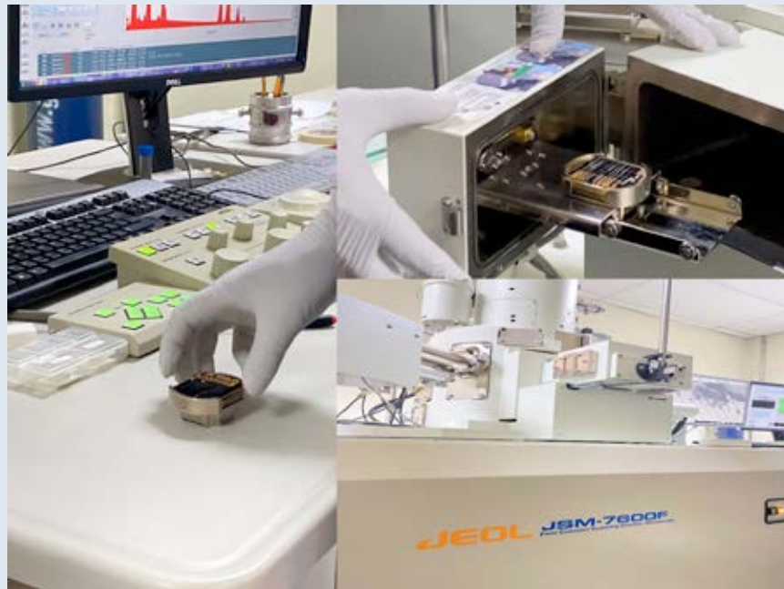
Figura 3. Inserción de los instrumentos al microscopio electrónico de barrido de emisión de campo
