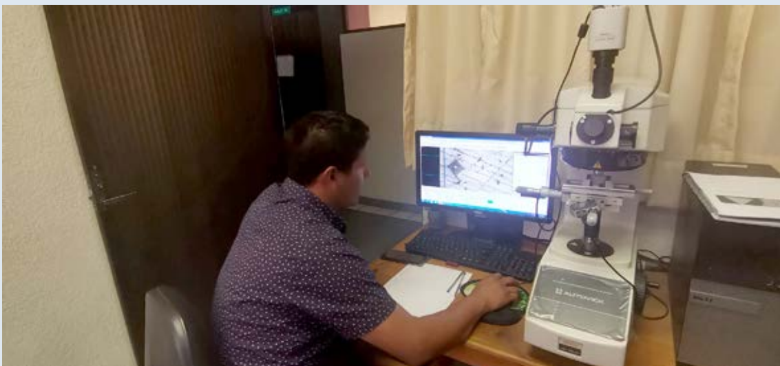
Fig. 19 Laboratorio e indentador Vickers Autovick® Mitutoyo HM-200
