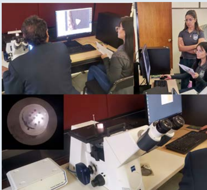
Figura 7. Microscopio óptico a 5X Zeiss® Axio Observer®, obteniendo fotomicrografía de la parte activa en corte transversal.
