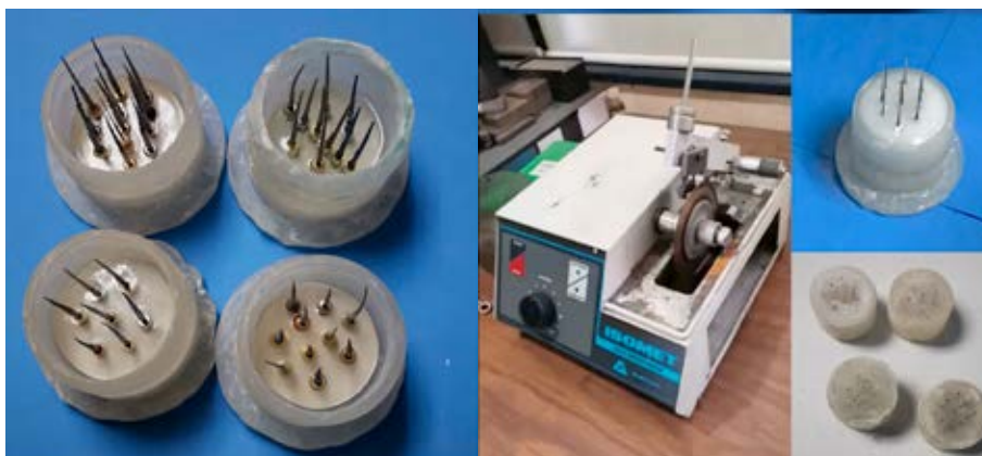
Figura 6. Fabricación del dispositivo para montaje de las muestras, con intención de conocer el diseño transversal de los instrumentos y prueba de microdureza de Vickers (HV)
