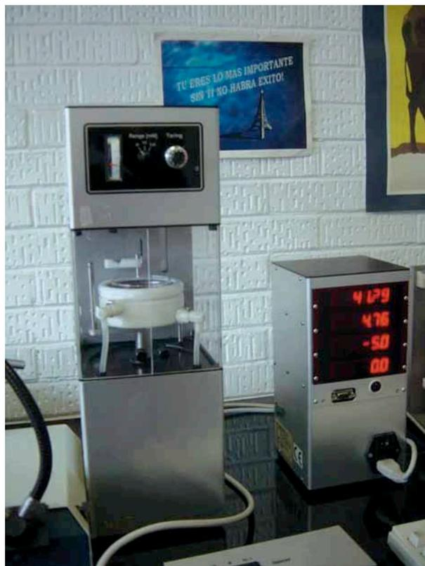
Fig. 4. Tensiómetro de Du Noüy, monitoreando temperaturas.
