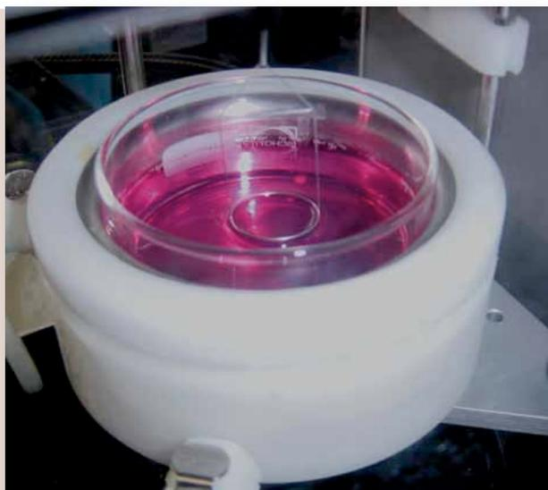
Fig. 1. Anillo del Tensiómetro de Du Noüy
