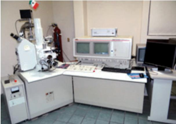
Figura 1. Microscopio electrónico de barrido JEOL JSM-6400.
