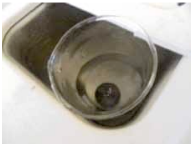
Fig. 5. Proceso de limpieza por ultrasonido.
