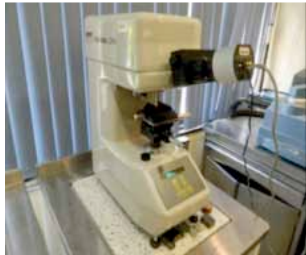
Fig. 8. Microdurómetro Zwick/Roell Indentec.
