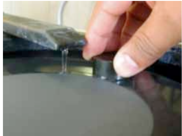
Fig. 3. Muestra en proceso de desbasteo.
