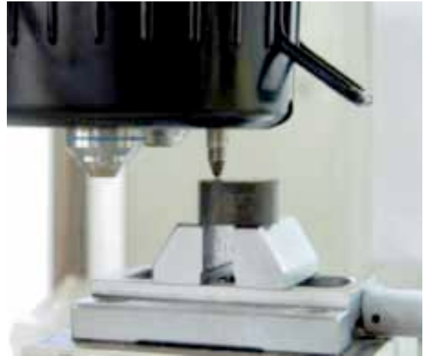
Fig. 9. Detección de la microdureza Vickers: Identación en el instrumento rotatorio embiuetado.
