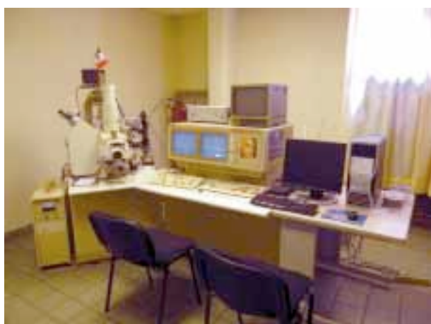
Fig. 6. Microscopio electrónico de barrido JEOL JSM-6400.
