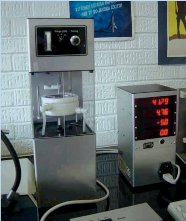
Fig. 4. Tensiómetro de Du Noüy, monitoreando temperaturas
